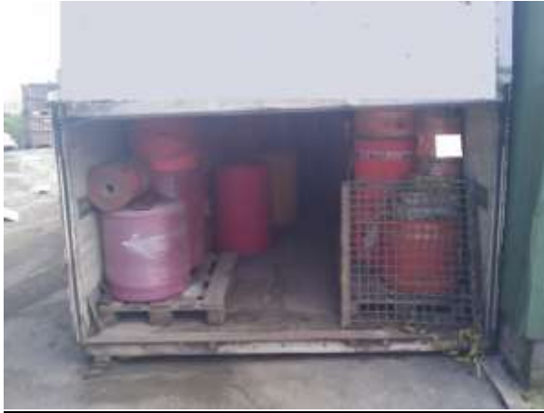
Abbildung 9: Verpackungsmaterial steht ungeschützt im Freien: Kontamination des Verpackungsmaterial
