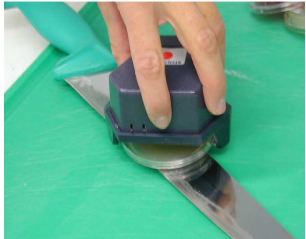
Abb. 2: Probenahme desinfizierte Oberfläche
