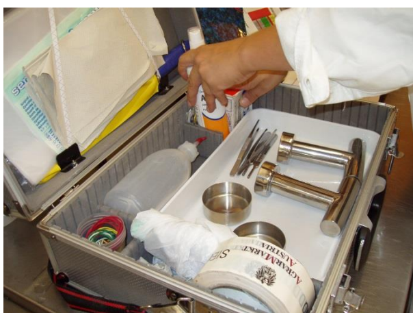
Abb. 1: Probenahmeausrüstung zur bakteriologische Schlachtkörperuntersuchung
