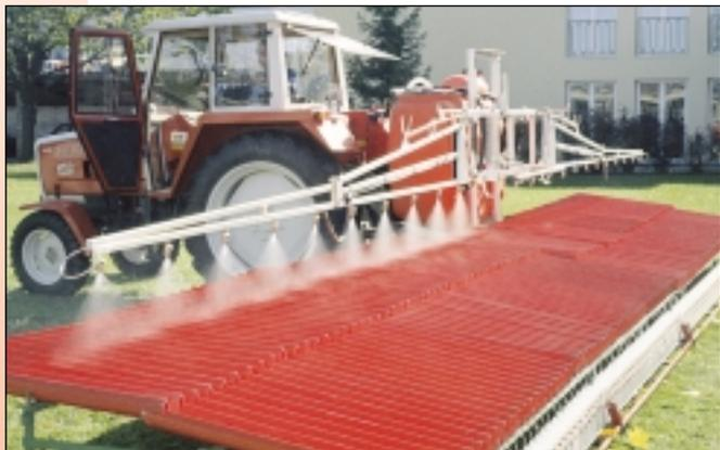
Vor allem die exakte Querverteilung der Spritzflüssigkeit ist für eine sichere, umweltschonende und kostensparende Ausbringung der Präparate wichtig. Ohne entsprechende Prüfstände ist eine Beurteilung jedoch nicht möglich.
